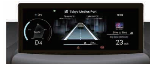
<日本精機:液晶バックライト制御による薄型メーター>
