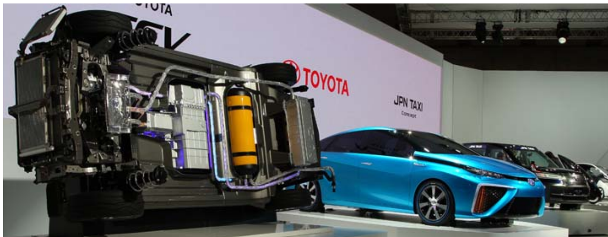
(セダンタイプの専用ボディに、小型・軽量化した自社開発の新型燃料電池や70MPa高圧水素タンク2本を床下に配置した高効率パッケージ。)
