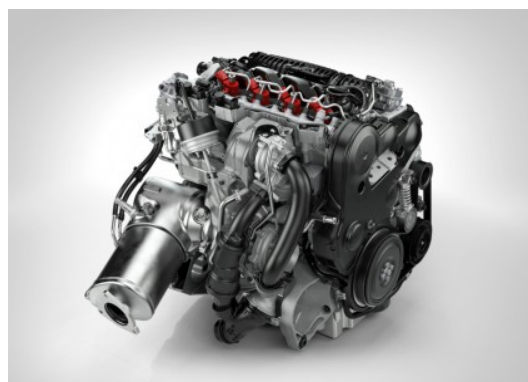
2,500 気圧コモンレールシステムを採用した Volvo Cars の 2.0ℓ Drive-E ディーゼルエンジン
