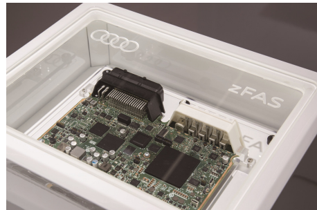
会場に展示されていた、第 2 世代 zFAS。zFAS は Central Vehicle Autonomous System の意味のドイツ語略。自動運転をコントロールする車両制御装置。
