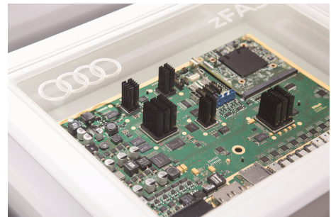
同様に展示されていた、第 1 世代 zFAS。第 2 世代は第 1 世代から小型化。Tegra VCM を搭載。
